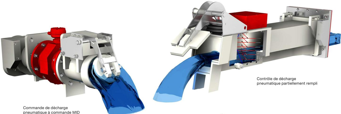
Commande de décharge pneumatique à commande MID
