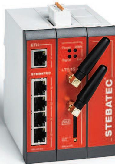
Le hardware de STEBalarm comprend un modem réseau fixe, un switch Ethernet, un modem radio mobile jusqu'à 4G ainsi qu'un routeur et un firewall.
