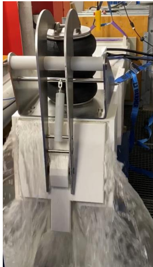
Abbildung 3: Das System wurde vor Auslieferung im Hydrauliklabor der STEBATEC kalibriert, geprüft und voreingestellt.
