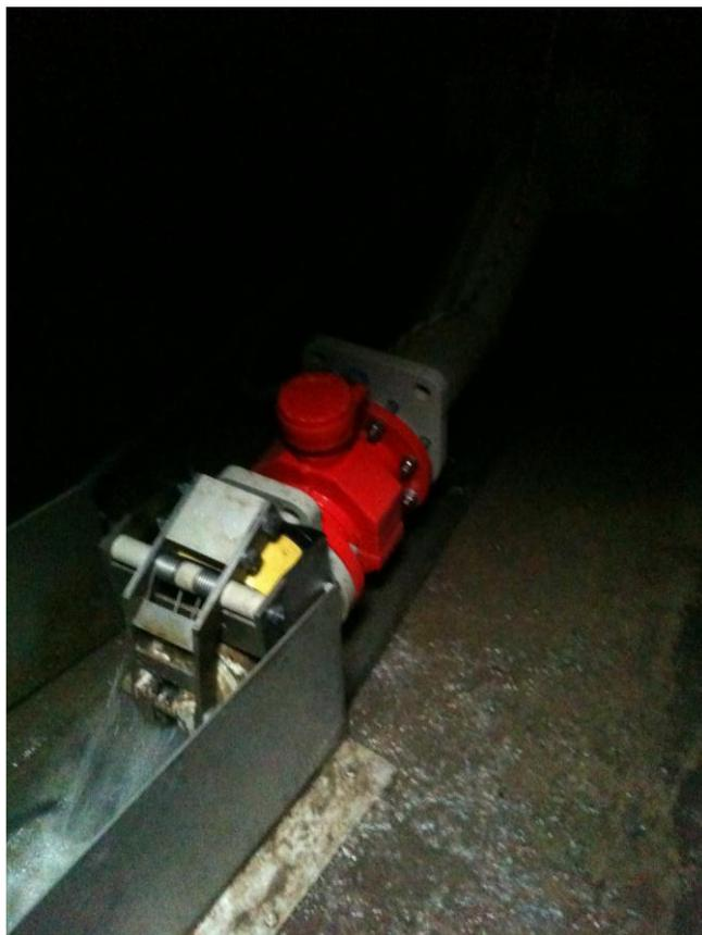
La régulation pneumatique de l'écoulement peut être intégrée dans le conduit existant et ce, sans mesures constructives.
