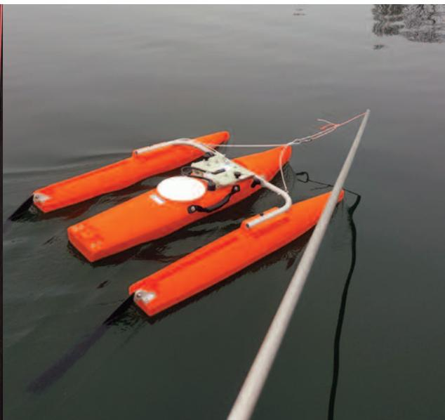
Mit mehreren ADCP-Messungen wurden die Messstelle kalibriert, indem bei unterschiedlichen Abflüssen Vergleichsmessungen durchgeführt wurden.
